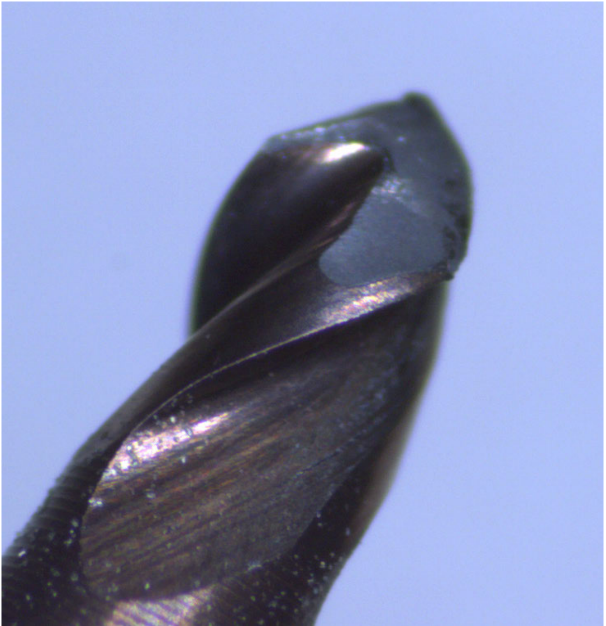
Darstellung 7: Werkzeugverschleiß des Fräsers 7
