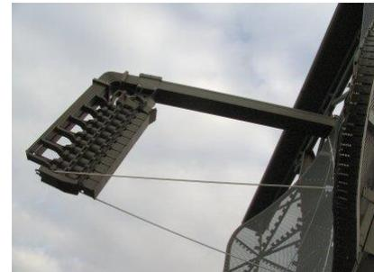
*Abbildung 9 Foto einer Cosecans<sup>2</sup>-Antenneneinheit*
