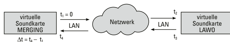
Abb. 20: Messaufbau zur Messung der Latenz zwischen zwei virtuellen Soundkarten
