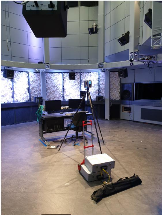
**Abbildung 4** Laserscanner im Tonlabor
