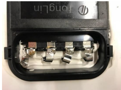
Abb. 14: Geöffnete Anschlussdose mit defekter Lötstelle [9]
