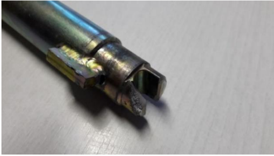
Abbildung 23: Defekter Spannungshebel bei der Station [9]
