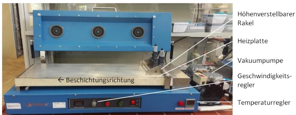
**Abbildung 11: Aufbau des Long Tape Casting Coaters MSK-AFA-L800-BH**
