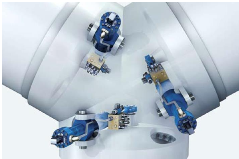
Abbildung 6: Hydraulisches Pitch-System in der Rotornabe (Hau, 2014, p. 357)
