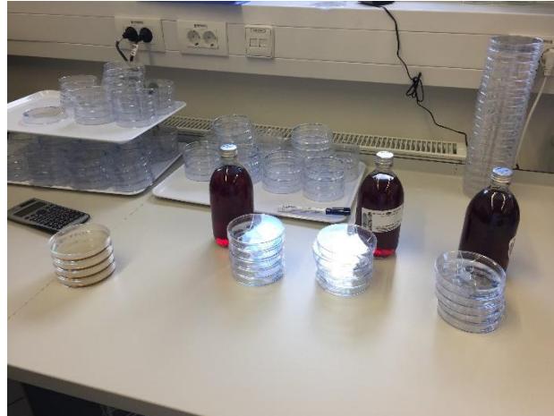
AVI- Abbildung 3: Angesetzte Petrischalen mit unterschiedlichen Zielkeimen für die Dreifachbestimmung pro Testdurchlauf und bereits gegossener Referenz-Agar für die erforderlichen Zielkeime des Nährmediums (VRBD)
