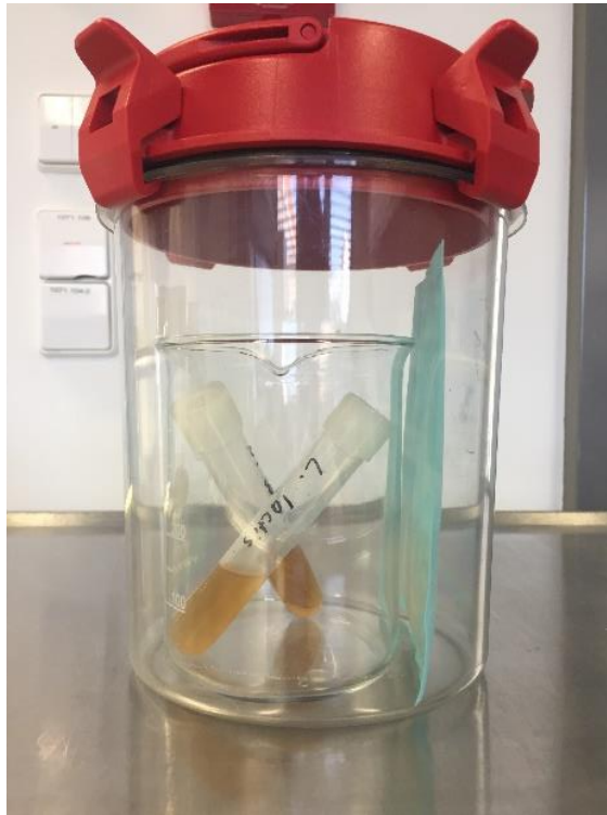
AV- Abbildung 2: Anaerobtopf inklusive Becherglas mit angeimpften Zellen und Anaerobebeutel
