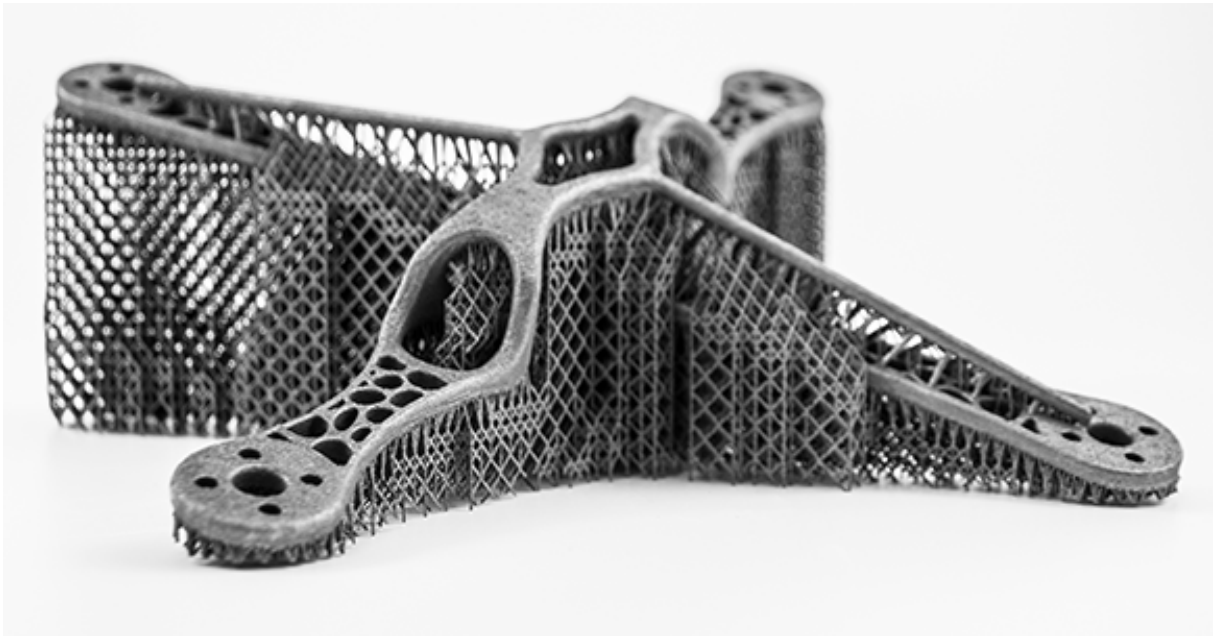
Abbildung 5: Bauteil mit Stützstrukturen
