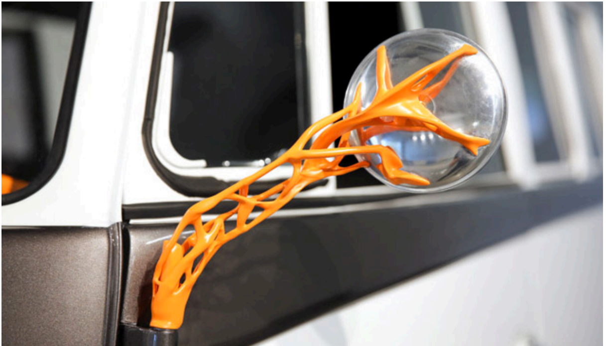
Abbildung 21: Spiegelhalter aus dem 3D-Drucker (Quelle: https://www.autodesk.de/redshift/zukunft-automobildesign-generatives-design/ )
