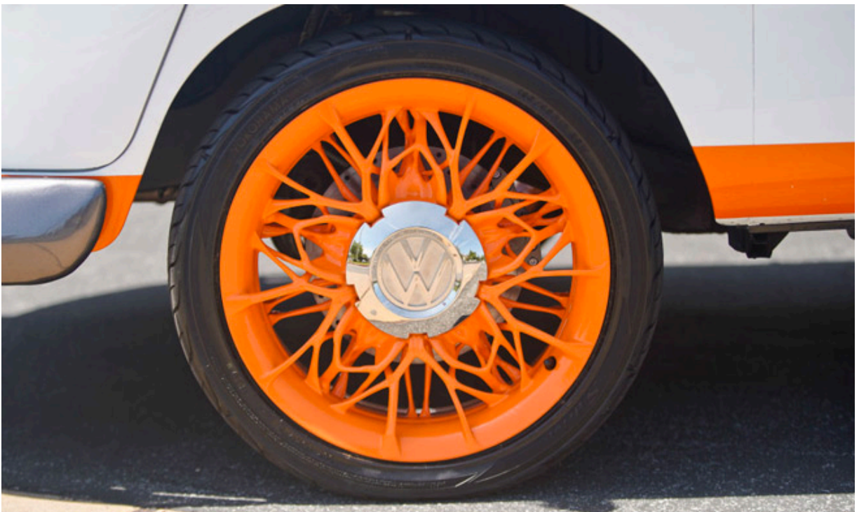
Abbildung 22: Generatives Design einer Felge (Quelle: https://www.autodesk.de/redshift/zukunft-automobildesign-generatives-design/ )
