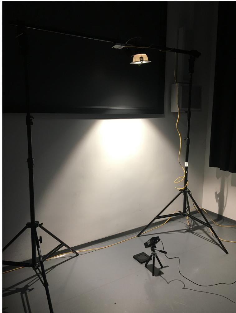
**Abbildung 26:** *Messaufbau der lichttechnischen Vermessung des Systems*
