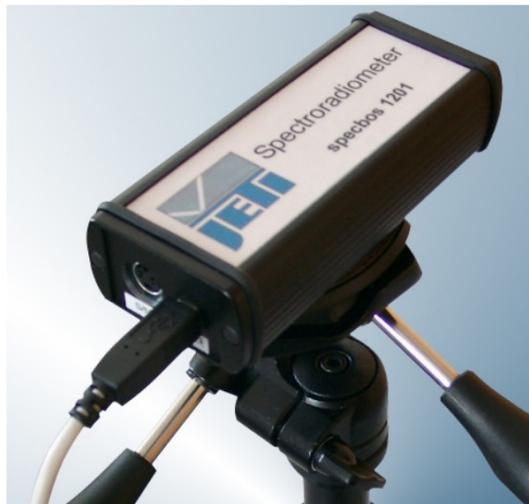
Abbildung 24: Spektroradiometer specbos 1201 der Firma JETI [12]
