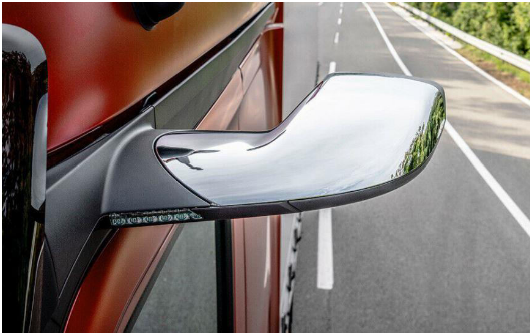
Abbildung 5: Mercedes Benz Actros als erster Serien-LKW mit MirrorCams 60
