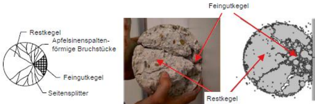
Abbildung 6: Bruchflächenverlauf und Simulation nach einem Aufprall einer Betonkugel [29, S.66]
