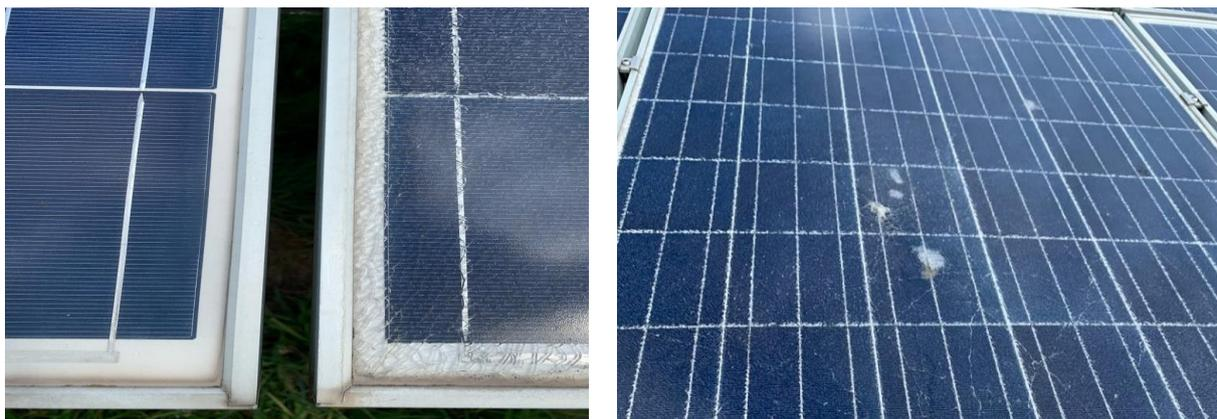
Abb. 10. links: Ein unbeschädigtes Modul im Vergleich zu dem Modul mit Glasbrüchen, rechts: Hot Spots auf einem Modul. (Eigene Aufnahmen)
