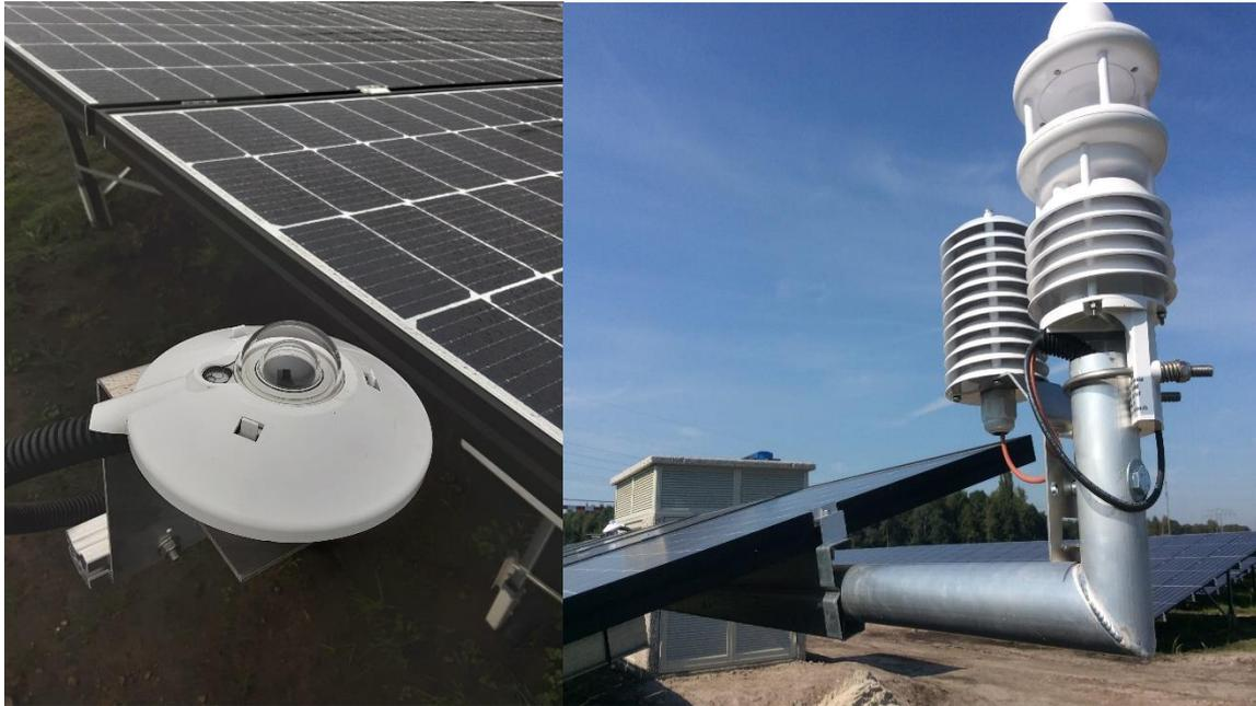
Abb. 4. Pyranometer und Wetter Station an dem Modulgestell. Anlage Heerenveen.
