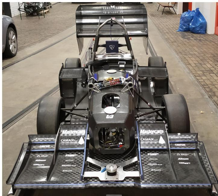
Abbildung 2.4: Position des LiDAR auf dem Frontflügel des Fahrzeugs
