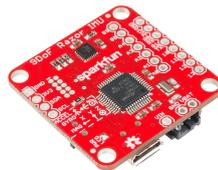
Abbildung 6.1.: Der 9DoF Razor IMU M0 ist eine Kombination, bestehend aus einem SAMD21-Mikroprozessor und einem 3-achsigen Low-cost-IMU-Sensor (MPU-9250 9DoF) [Electronics (2019)].
