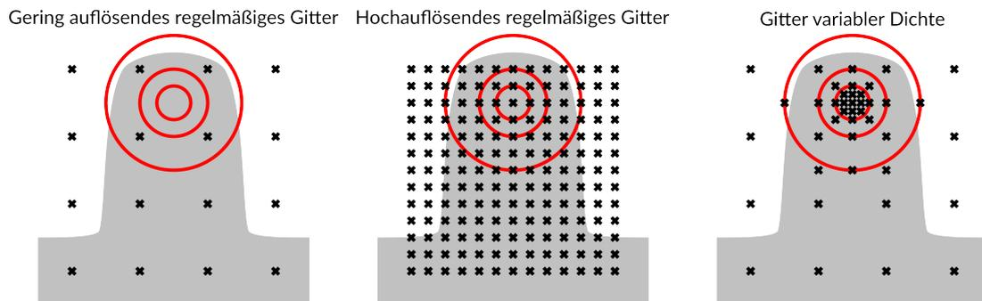
Abbildung 3.26.: In Gittern angeordnete Datenpunkte (schwarz). Die Gitter sind einem Modell (grau) zugeordnet, dessen besondere Regions of Interest (rot) einer hohen Auflösung bei der Optimierung bedürfen.
