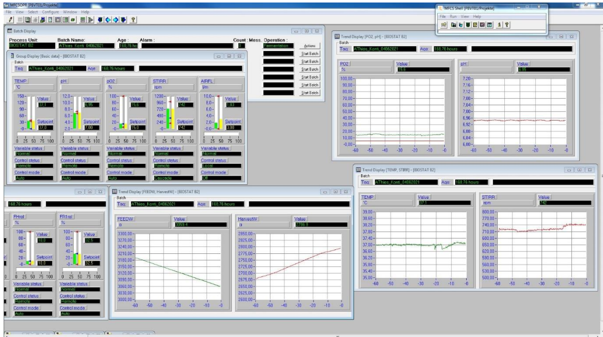
Abbildung 4.4: Screenshot von einer Anwendung innerhalb MFCS. Rechts und in der Mitte sind sechs sogenannte Trenddisplays zu sehen. Hier werden pO2%, pH (oben), Temperatur, Rührerdrehzahl (unten) und die Signale der Feed- und Harvestwaage (Mitte) angezeigt. Links sind zwei Groupdisplays geöffnet. Links unten wird die Pumprate der Feed- und Harvestpumpe angezeigt und kann nach Wunsch eingestellt werden, Mitte links sieht man die aktuellen Werte für die Temperatur, pH, pO2, Rührerdrehzahl und die Begasungsrate. Diese kann nicht über MFCS variiert werden. Links oben sind die verwendete DCU, der Prozessname, die Laufzeit und eventuelle Fehlermeldungen vermerkt.
