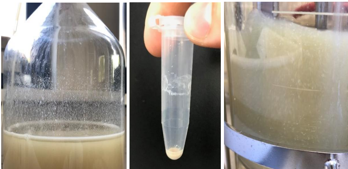
Abbildung 5.32: Links: Ernteflasche mit Zelllysat-Sprenkeln. Mitte: Mikroreaktionsgefäß mit BTM von 3 mL Probe nach 15 Minuten Zentrifugation bei 5500 g. Der schwache, weiße Film im oberen Bereich an der Gefäßwand besteht aus Zellbestandteilen lysierter Bakterien. Rechts: Bioreaktor mit sichtbarem Zelllysat im flüssigen Reaktorvolumen.
