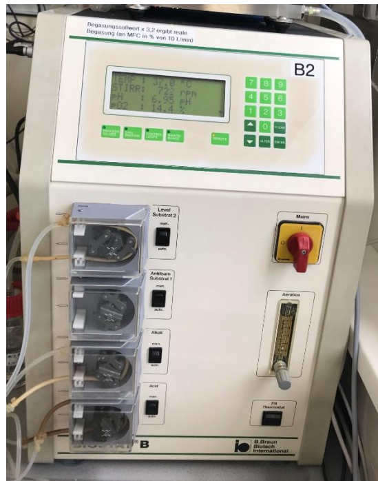
Abbildung 4.3: Digital Control Unit Typ 8840334 von Sartorius Stedim Biotech. Die digitale Anzeige zeigt Prozessparameter an (Temperatur in °C, Rührerdrehzahl in rpm, pH und pO 2 in %). Die Kalibrierung von Sonden und Pumpen erfolgt über das Display direkt an der DCU. Links sind die vier Pumpen, die auf manuell (Dauerbetrieb), auto (An-Aus-Regelung) oder ausgestellt werden können, angebracht. Rechts ist ein Rotameter zur Kontrolle der Begasungsrate montiert. Unter dem Rotameter befindet sich ein Schalter zum Befüllen des Doppelmantels des Kultivierungsgefäßes. Die Anschlüsse für Kühlwasser und Zuluft befinden sich auf der linken Seite des Gerätes.
