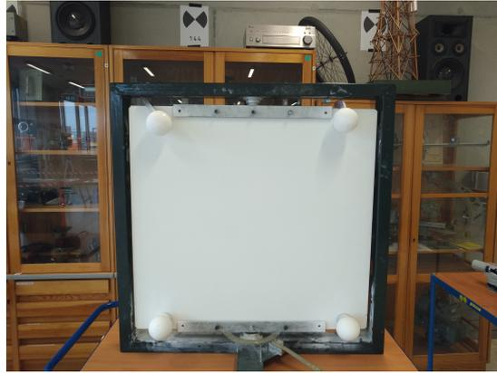
Abbildung 6.6: Messaufbau zur Prüfung der Ebenheitsabweichung
