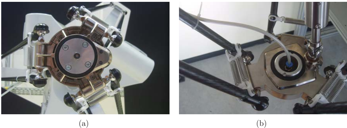
ABBILDUNG 4.3: Installation des Greifmechanismus am TCP des Hornet 565. (a) Ansicht von Unten. (b) Ansicht von Oben.
