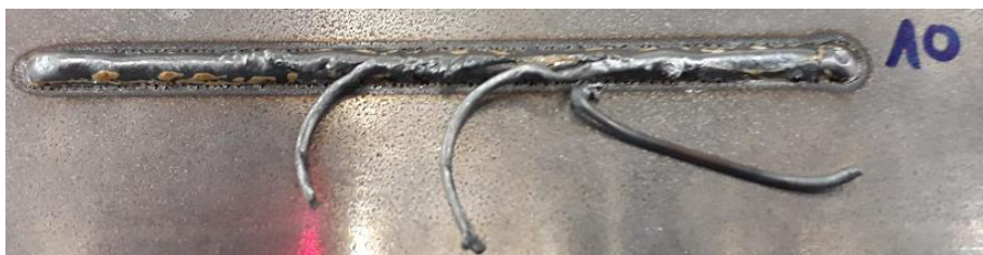
Abbildung 77 Schweißergebnis von Set P10 nach Lage 3
