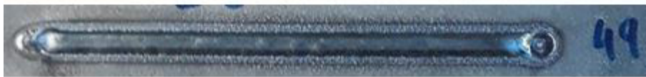
Abbildung 127 Raupen mit a = 1 , b = 0,65 mm, h = 0,7 mm und l = 10 mm (Set ab21)
