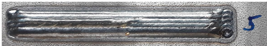
Abbildung 135 Beschichtung mit \Delta x = 1,4 \text{ mm} und h = 0,5 \text{ mm} (Set V5)
