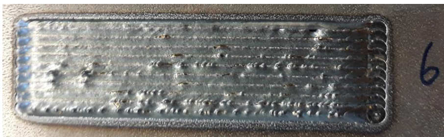
Abbildung 144 Beschichtung ( n=10 ) mit \Delta x = 1,8 \text{ mm} und h = 0,1 \text{ mm}
