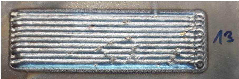
Abbildung 146 Beschichtungen ( n=10 ) mit \Delta x = 2 \text{ mm} und h = 0,1 \text{ mm}
