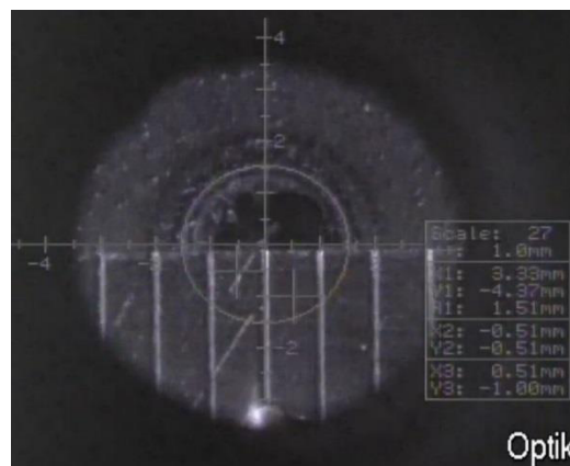
Abbildung 42 Validierung der Achsenskalierung mittels Stahlmaß
