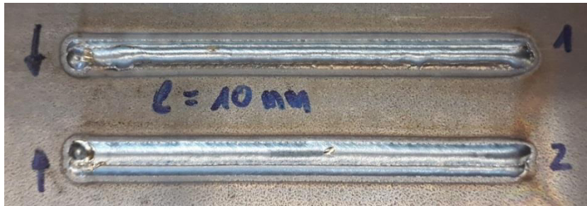
Abbildung 55 Schweißung mit umgekehrter (1) und gewöhnlicher (2) Versatzrichtung
