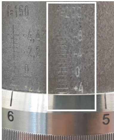
Abbildung 32 Kollimation für einen 3mm-Spot bei einem 318mm-Abstand
