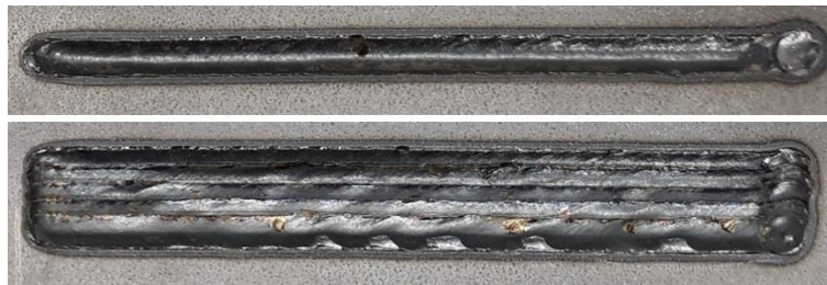
Abbildung 53 Einzelraupe und Beschichtung ( n = 5, \Delta x = 1,5 \text{ mm} ) auf Kreide-Grundierung
