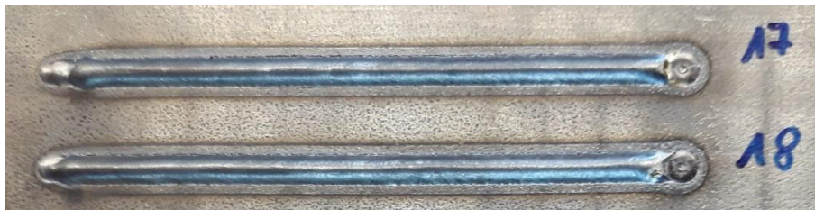
Abbildung 104 Raupen mit l = 12,5 \text{ mm} und h = 0,7 \text{ mm} (Set I5)
