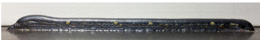
Abbildung 60 Fünfflagige Wand mit veränderten Delay-Zeiten
