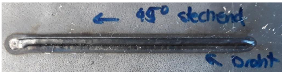
Abbildung 88 Raupe mit \beta = 135^\circ (seitlich-stechend)
