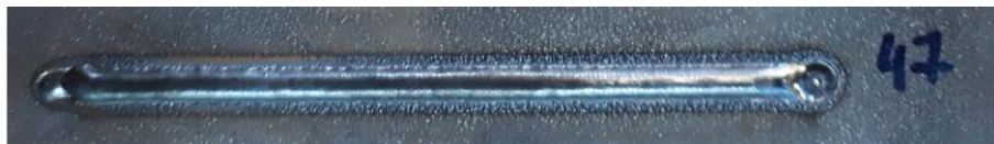
Abbildung 126 Raupe mit a = 1 , b = 0,65 mm, h = 0,7 mm und l = 12,5 mm (Set ab20)
