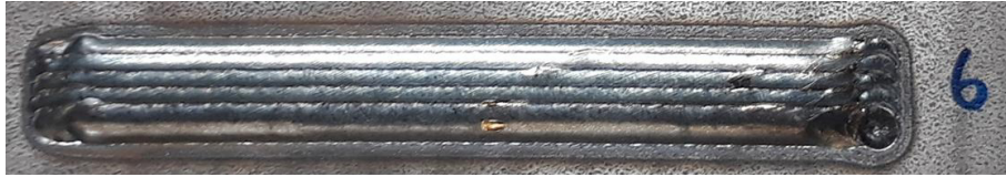
Abbildung 136 Beschichtung mit \Delta x = 1,4 \text{ mm} und h = 1 \text{ mm} (Set V6)
