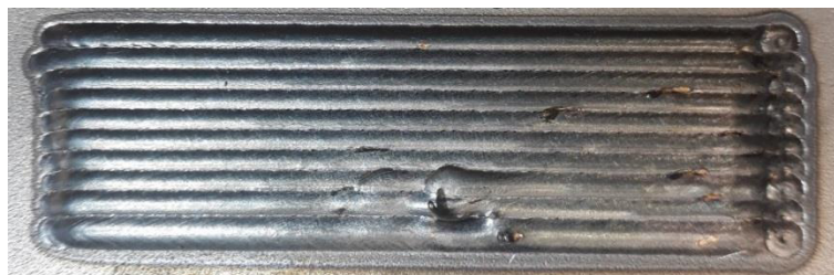
Abbildung 52 Beschichtung ( n=10 , \Delta x = 1,9 \text{ mm} ) auf sandgestrahltem Blech
