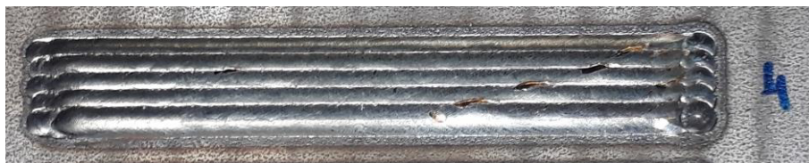
Abbildung 134 Beschichtung mit \Delta x = 1,8 \text{ mm} und h = 0,5 \text{ mm} (Set V4)
