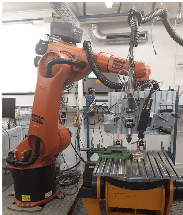
Abbildung 16 Bearbeitungseinrichtung zum Laserschweißen
