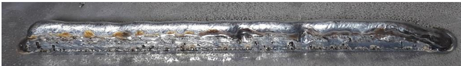
Abbildung 158 Wand 1 nach dem Schweißen von Lage 7
