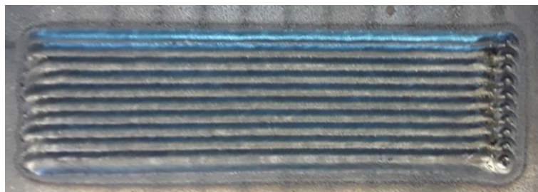
Abbildung 51 Beschichtung ( n=10 , \Delta x = 1,9 \text{ mm} ) auf Graphit-Grundierung
