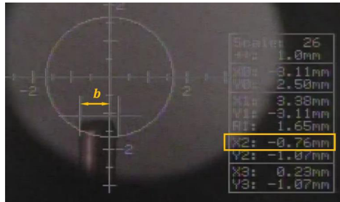
Abbildung 43 Positionierung für b = 0,76 \text{ mm}
