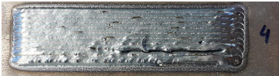
Abbildung 142 Beschichtung ( n=10 ) mit \Delta x = 1,6 \text{ mm} und h = 0,1 \text{ mm}
