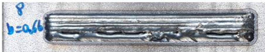
Abbildung 153 Beschichtungen mit b = 0,66 \text{ mm} (Set S6)
