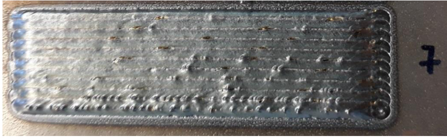
Abbildung 145 Beschichtung ( n=10 ) mit \Delta x = 1,9 \text{ mm} und h = 0,1 \text{ mm}
