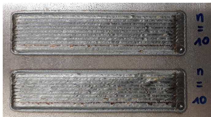
Abbildung 69 Beschichtungen mit h = 0,5 \text{ mm} und \Delta x = 1,5 \text{ mm} (oben) bzw. \Delta x = 1,4 \text{ mm}
