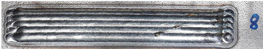
Abbildung 138 Beschichtung mit \Delta x = 1,9 \text{ mm} und h = 0,5 \text{ mm} (Set V8)
