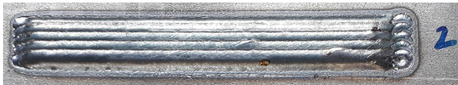
Abbildung 132 Beschichtung mit \Delta x = 1,6 \text{ mm} und h = 0,5 \text{ mm} (Set V2)
