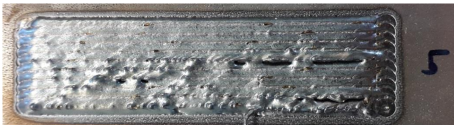
Abbildung 143 Beschichtung ( n=10 ) mit \Delta x = 1,7 \text{ mm} und h = 0,1 \text{ mm}
