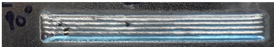
Abbildung 148 Beschichtung mit \alpha = 90^\circ (Set S1)
