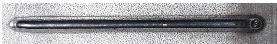
Abbildung 36 Schweißergoßnis mit Delays von 100ms (Start) bzw. 300ms (Ende)
