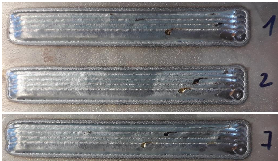
Abbildung 140 Beschichtungen ( n=5 ) mit \Delta x = 1,5 \text{ mm} und h = 0,1 \text{ mm}
