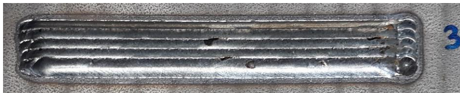
Abbildung 133 Beschichtung mit \Delta x = 1,7 \text{ mm} und h = 0,5 \text{ mm} (Set V3)
