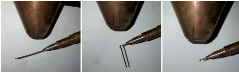
Abbildung 49 Zustände nach dem Durchtrenn-Prozess: keine (links), unvollständige (mittig) und vollständige Durchtrennung (rechts)
