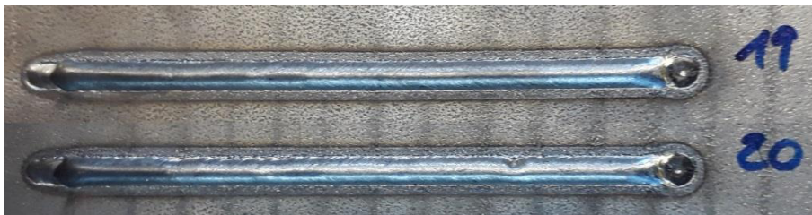
Abbildung 105 Raupen mit l = 12,5 \text{ mm} und h = 1 \text{ mm} (Set I6)
