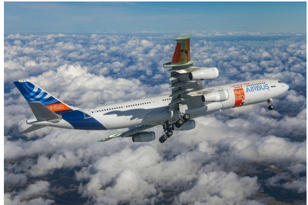
Das "BLADE"-Testflugzeug mit Laminarstruktur an den Flügeln.
