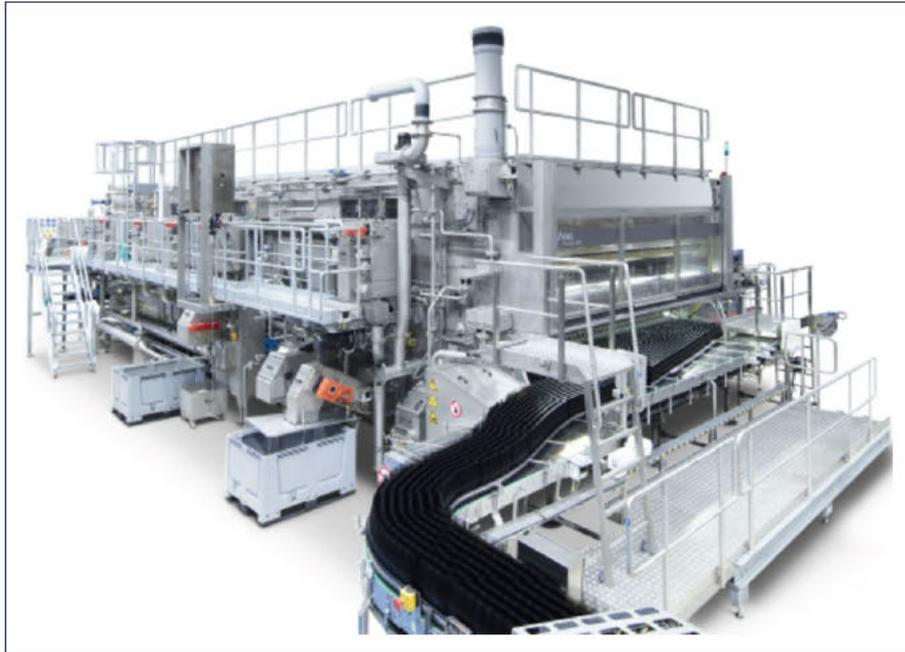
Abbildung 8: Flaschenreinigungsmaschine für Mehrwegflaschen<sup>53</sup>
