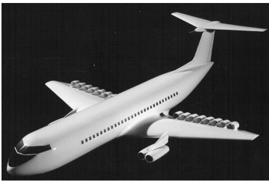
Bild 6.1 Beispiel für Distributed Propulsion (Polenta 2015)
