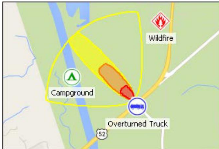
Abbildung 13: Visualisierung des Gefahrenbereichs bei einem Gefahrstoffaustritt auf Kartengrundlage [vii]
