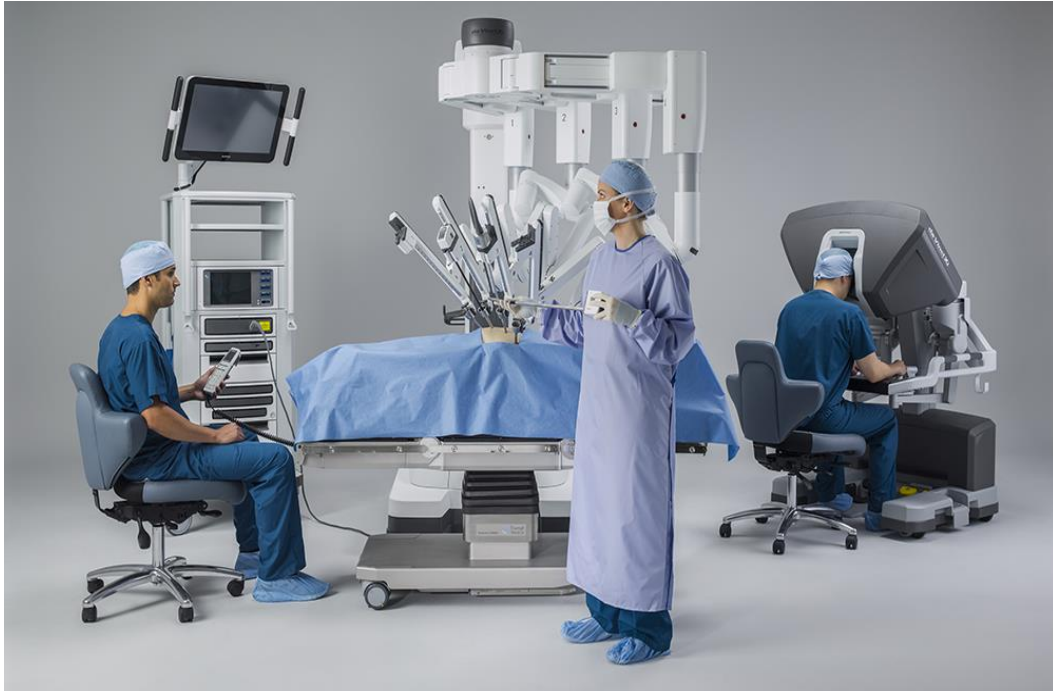
Abbildung 1: Da-Vinci-Operationssystem bestehend aus drei operierenden Modulen: Vision Cart (links), Patient Cart (Mitte) und Surgeon's Console (rechts), Rudolph-Witt, 2016
