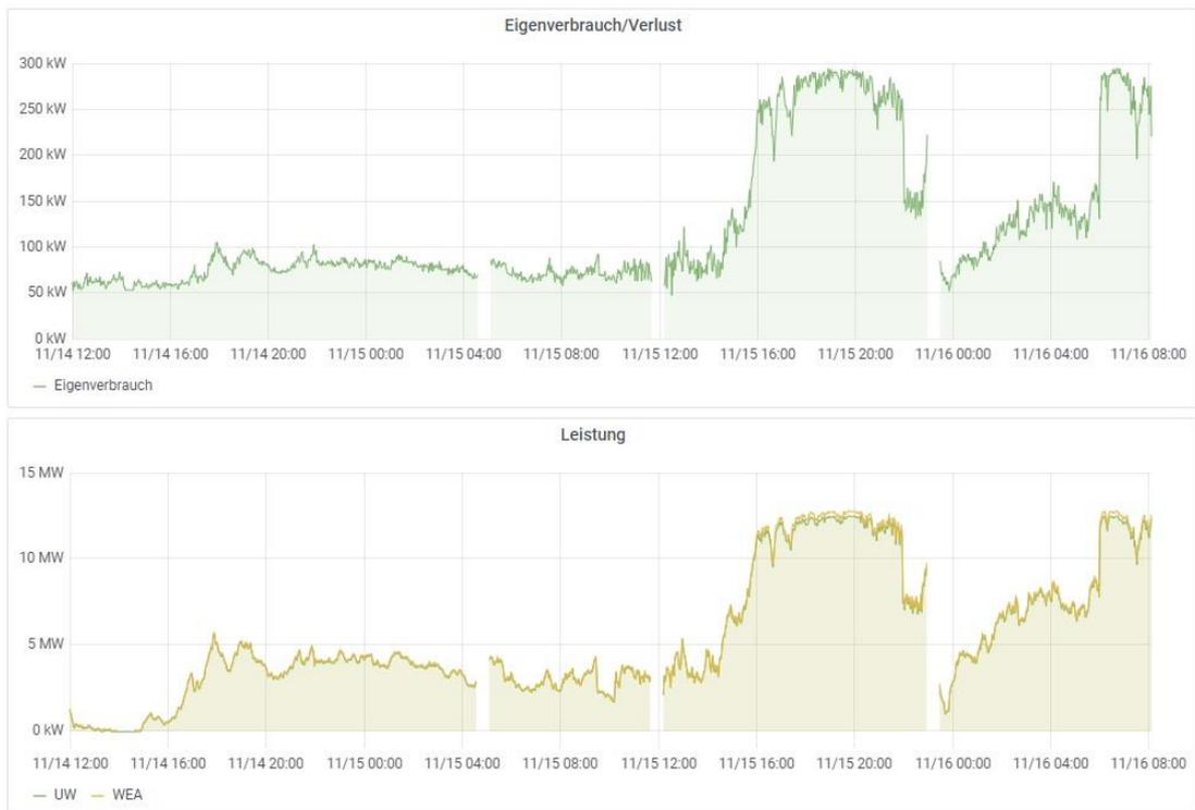
Abbildung 5.6 Gegenüberstellung der Erzeugungsleistung und der damit korrelierenden Eigenverbrauchsleistung des Windparks (eigene Darstellung)
