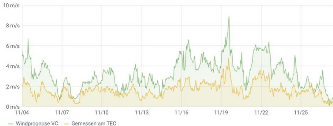
Abbildung 5.2 Vergleich prognostizierter Windgeschwindigkeiten mit Messwerten vom Dach des TEC über drei Wochen (eigene Darstellung)
