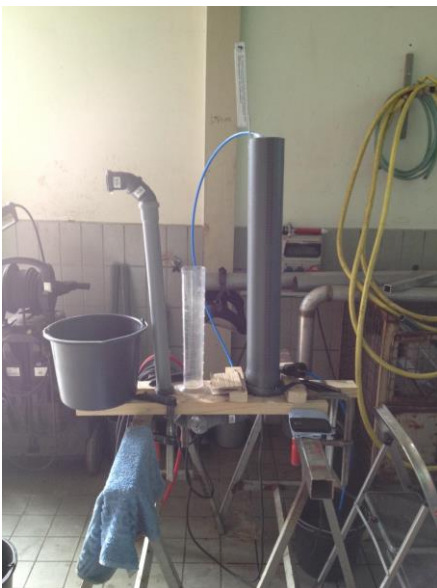
Abb. 2: Zeigt den Versuchsaufbau mit eingebauten Y-Stück. Zur besseren Erfassung des Überstandes wurde das HT-Rohr mit DN 110 auf etwa 750 mm Länge gekürzt.
