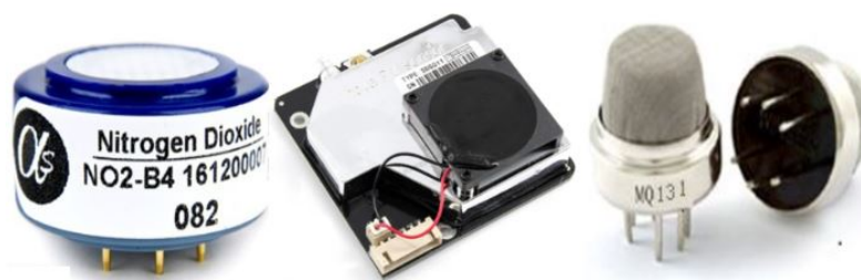
Abbildung 2: Beispiele für OEMS v.l.n.r.: NO2-B4 (Alphasense) [11], SDS011 (Nova Fitness) [9], MQ131 (Winsen) [10]
