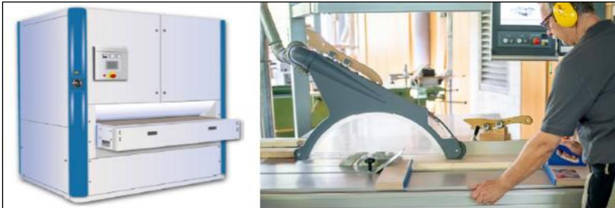
Abb. 1: Links Bsp. gekapselt (Breitbandschleifmaschine), rechts Bsp. offen (Formatkreissäge) [7, pp. 14-15]
