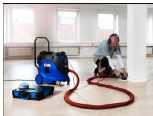
Abb. 3: Handgeführtes Werkzeug mit Absaugung durch einen ortsveränderlichen Entstauber [7, p. 17]
