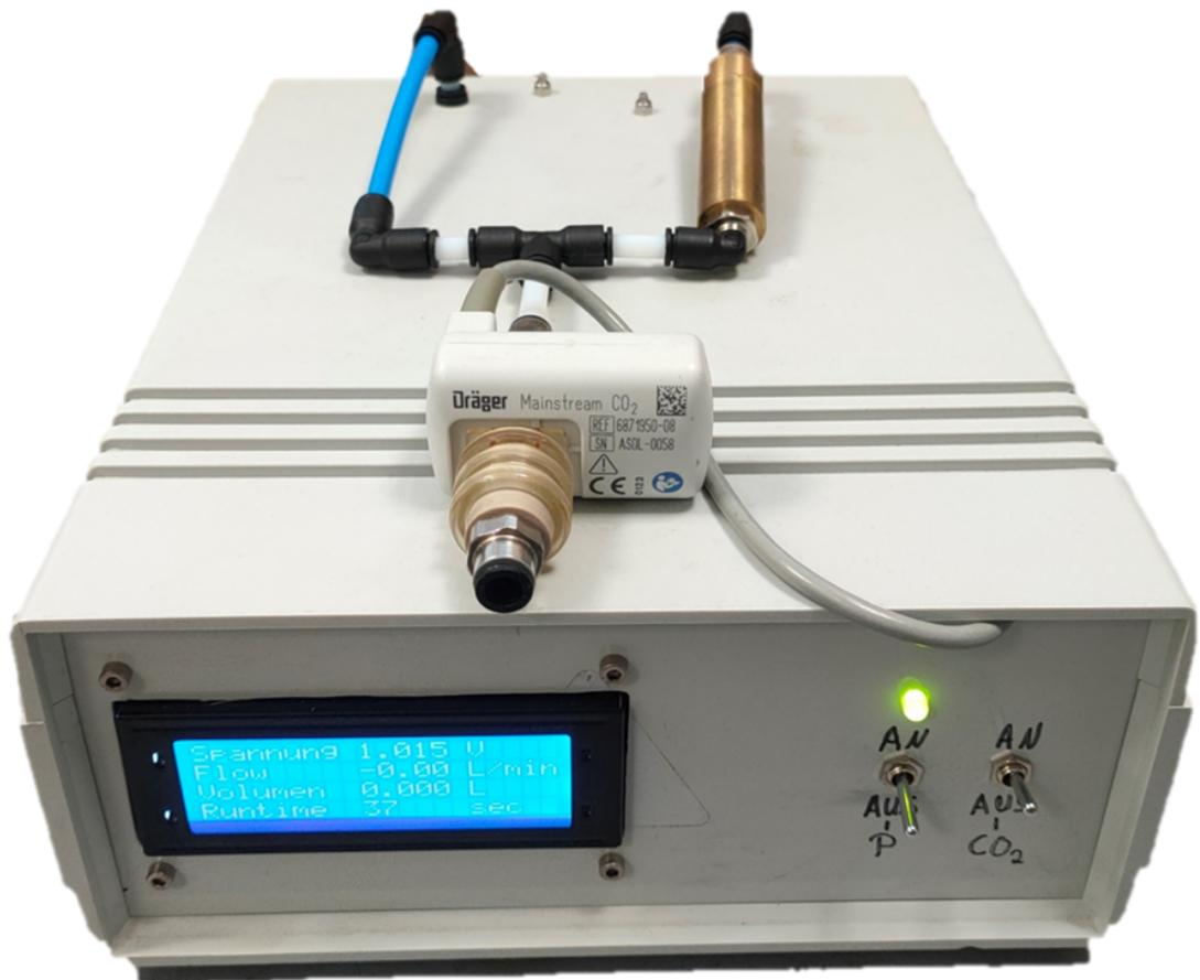
**Abbildung A.2:** Das Probennahmesystems. Auf der Frontseite ist das Display, sowie die Statusleuchtdiode und Schalter zur Steuerung der Pumpe (P) und der CO<sub>2</sub>-Triggerfunktion (CO<sub>2</sub>) verbaut. Auf dem Gerät ist der CO<sub>2</sub>-Sensor sowie die Kapsel aus Messing, die das Probenröhrchen hält, zu sehen.
