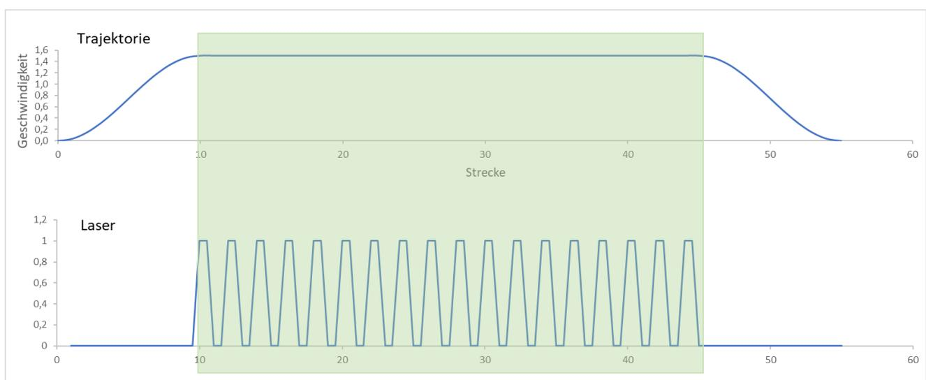
Abbildung 4: Gewünschte Geschwindigkeitskurve der Trajektorie (oben), Lasertriggersignale (unten)
