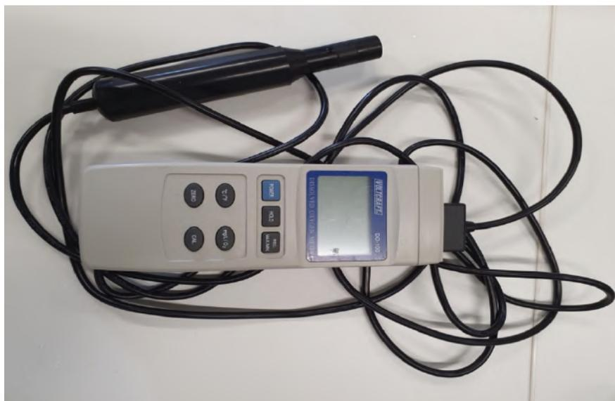
Abbildung 3-1: Sauerstoffmessgerät; „Dissolved Oxygen-meter D-100“ von der Firma Voltcraft
