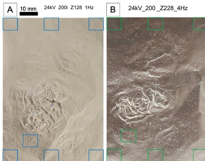
Abbildung 4-2: Bilder der Alufolie nach Beschallung mit der Stoßwelle mit einer Spannung von 24kV und 200 Impulsen: Bild A zeigt das Ergebnis der Messung bei einer Entfernung von 128 mm und einer Frequenz von 1 Hz. Bild B präsentiert das Resultat bei einer Entfernung von 228 mm und einer Frequenz von 4 Hz.
