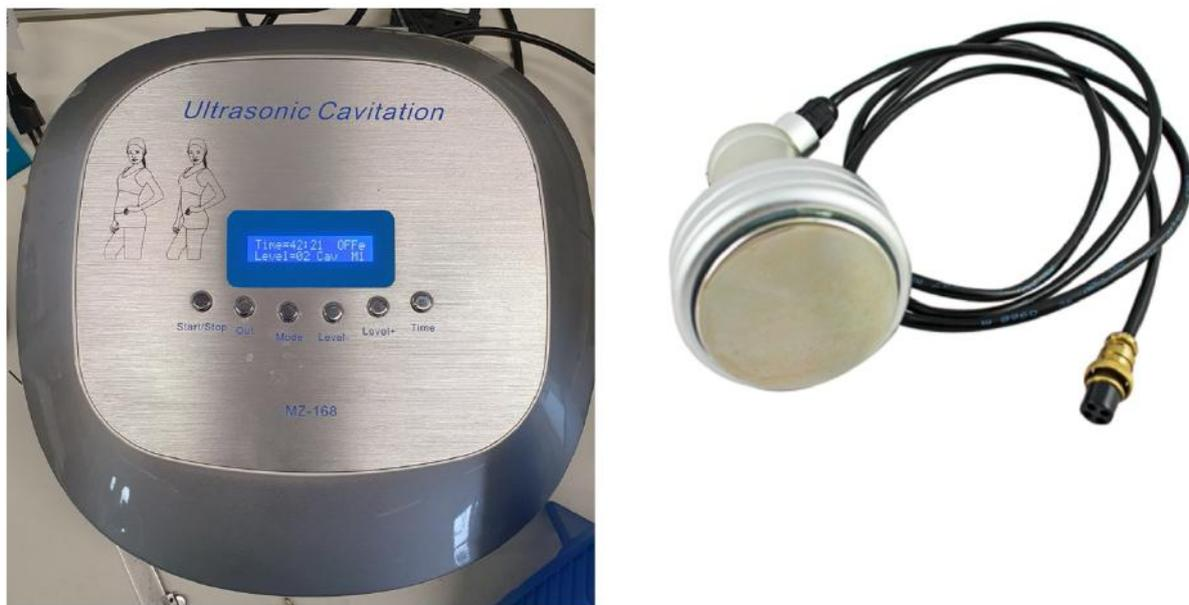
Abbildung 3-10: Steuergerät für den Piezowandler links und sein Schallwandler rechts
