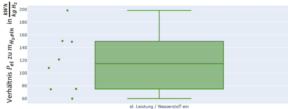
Abbildung 31: Verhältnis zwischen elektrischer Leistung und Wasserstoff am Eingang der Methanisierung
