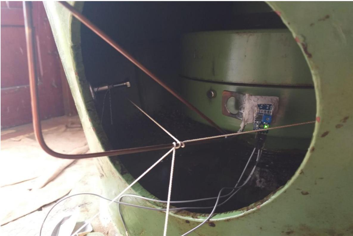
Abbildung 10: Messaufbau der Lichtschranke an der Kupplung der Pumpe
