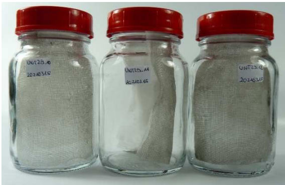
Abbildung iii Schwerölproben nach 3 Monaten tiefgekühlt
