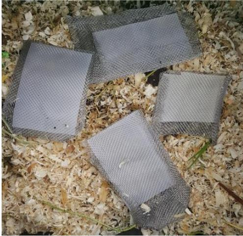
Abbildung 8: Prüfmateriale eingeschlagen in grobmaschigem Drahtnetz bei Versuchsbeginn
