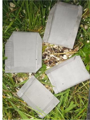
Abbildung 9: Prüfmateriale eingeschlagen in feinmaschigem Drahtnetz bei Versuchsbeginn
