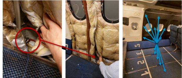
**Abbildung 3:** Transferpfadanalysen der Strukturschallpfade
