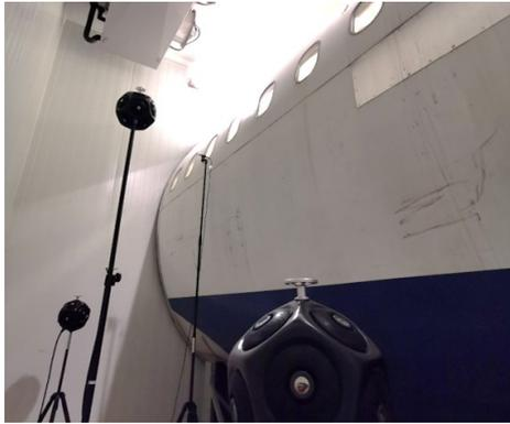
**Abbildung 1:** Schallanregung von außen auf A320 Rumpfssegment mit drei Lautsprechern ca. 109 dBA
