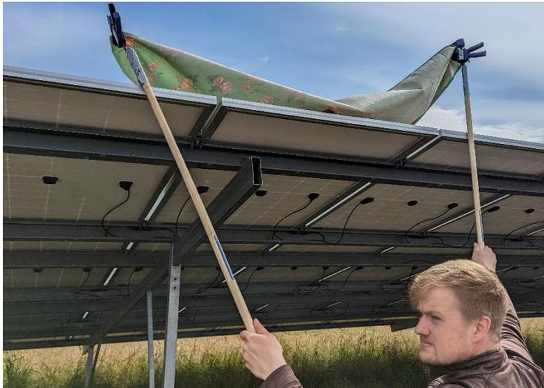
Abbildung 34: Platzierung der Decke am Modul Strang zur Wolken Simulation (helfende Person: Martin Dassau)
