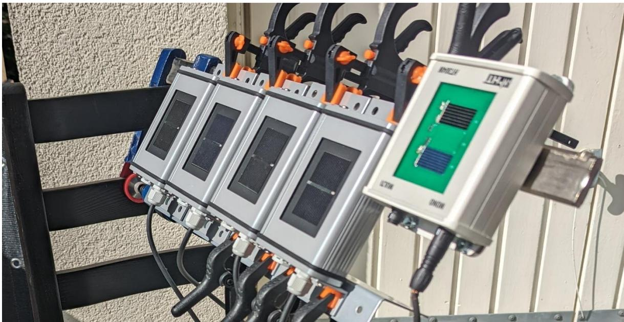
Abbildung 25: Testaufbau der vier Einstrahlungssensoren und dem Referenzsensor auf dem Balkon
