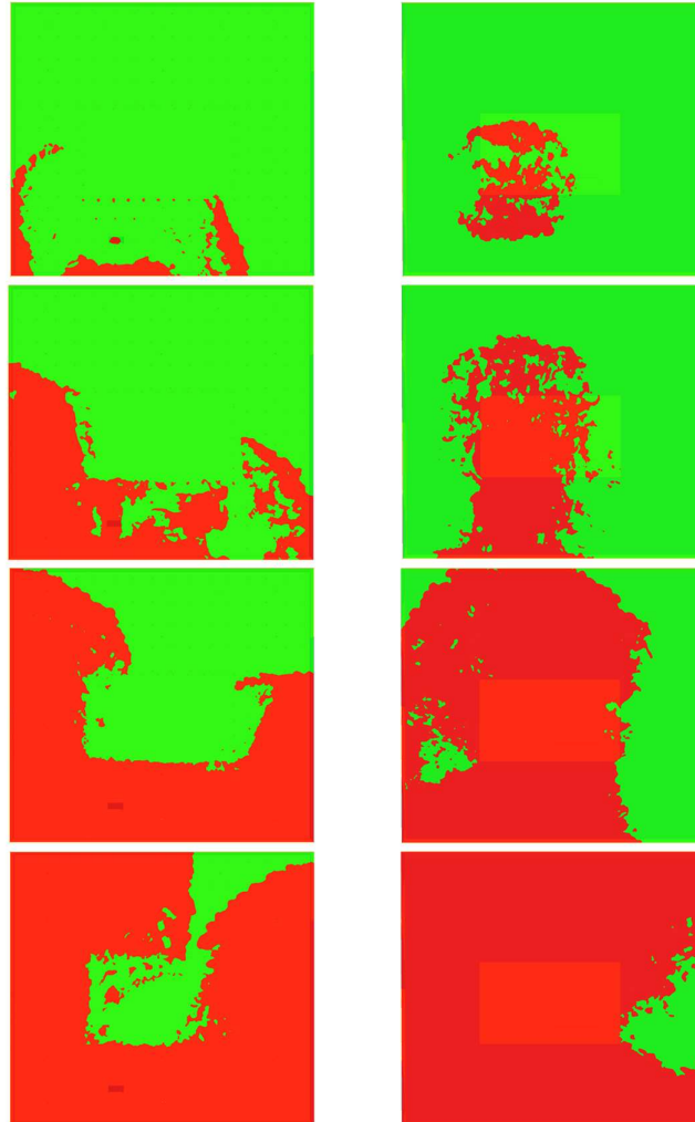
Abbildung 15: Simulation 3 - Grenzwertbetrachtung der Sichtweite nach 50, 80, 110 und 140 s, Höhe 2 m (links) und 4,6 m (rechts), (rot \leq 10 m; grün = Akzeptanzbereich)
