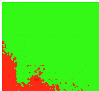
Abbildung 17: Simulation 3 - Grenzwertbetrachtung der Temperatur nach 120 s, Höhe 2 m, (rot \geq 60 °C; grün = Akzeptanzbereich)
