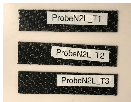
Abbildung 16 Materialzuschnitte 3 Punkt Biegung
