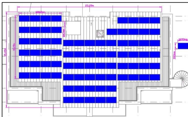
Abbildung 14 Modulverteilung bei Süd Ausrichtung für Haus 1
