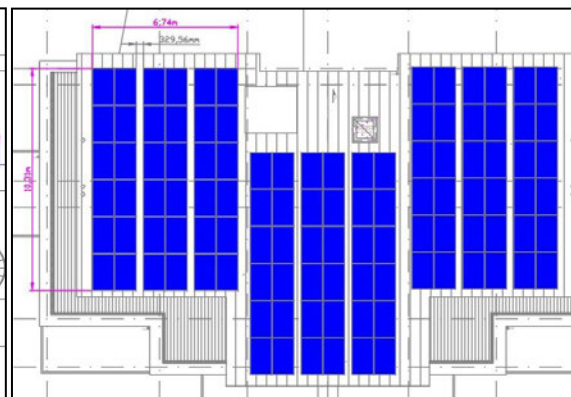
Abbildung 15 Modulverteilung bei Ost-West-Ausrichtung für Haus 1
