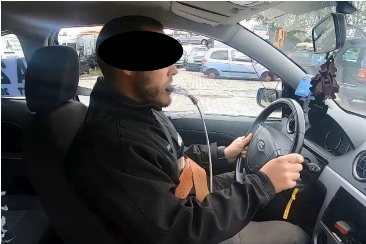
Abbildung 8: Exemplarische Darstellung der Verwendung von Kopf- und Brustsensoren. (Quelle: IFU-Hamburg)
