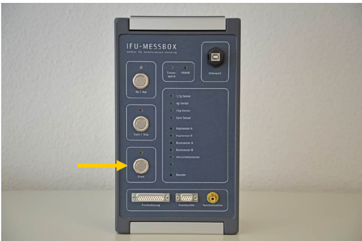
Abbildung 7: Frontpanel der Messbox – die IFU-Messbox beinhaltet vier Beschleunigungssensoren, um einen großen Messbereich festzuhalten. (Quelle: IFU-Hamburg)
