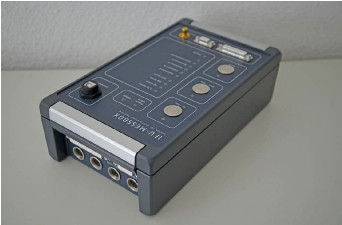
Abbildung 6: In den Versuchen verwendete Messbox des IFU Hamburg. (Quelle: IFU-Hamburg)
