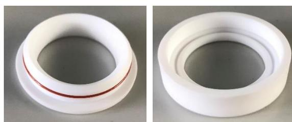
**Abbildung 11:** Rechts: Oberteil der PTFE-Spannvorrichtung; links: Unterteil der PTFE-Spannvorrichtung
