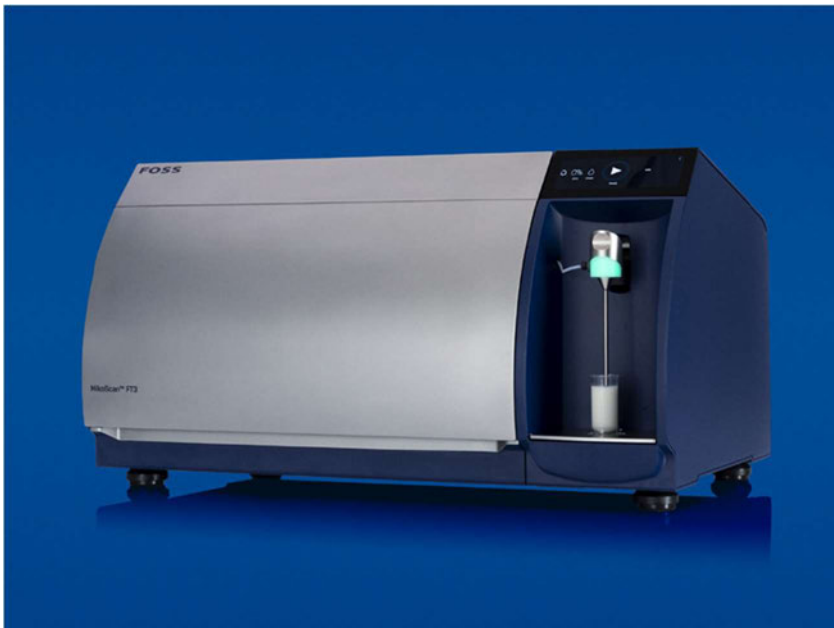
Abbildung 15: Messgerät Milkoscan FT3. (Foss GmbH, 2022)
