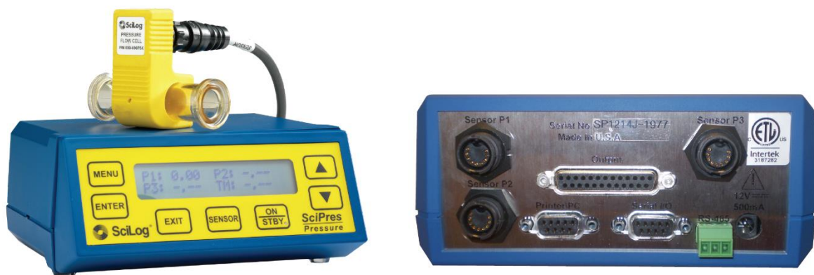
Abbildung 4.4: Abbildung des Druckmonitors der mobilen Drucksensoren. Links ist die Vorderseite inklusive Bildschirm dargestellt. Rechts zu erkennen sind die Anschlüsse auf der Rückseite des Monitors (Parker Hannifin Corporation, 2021).
