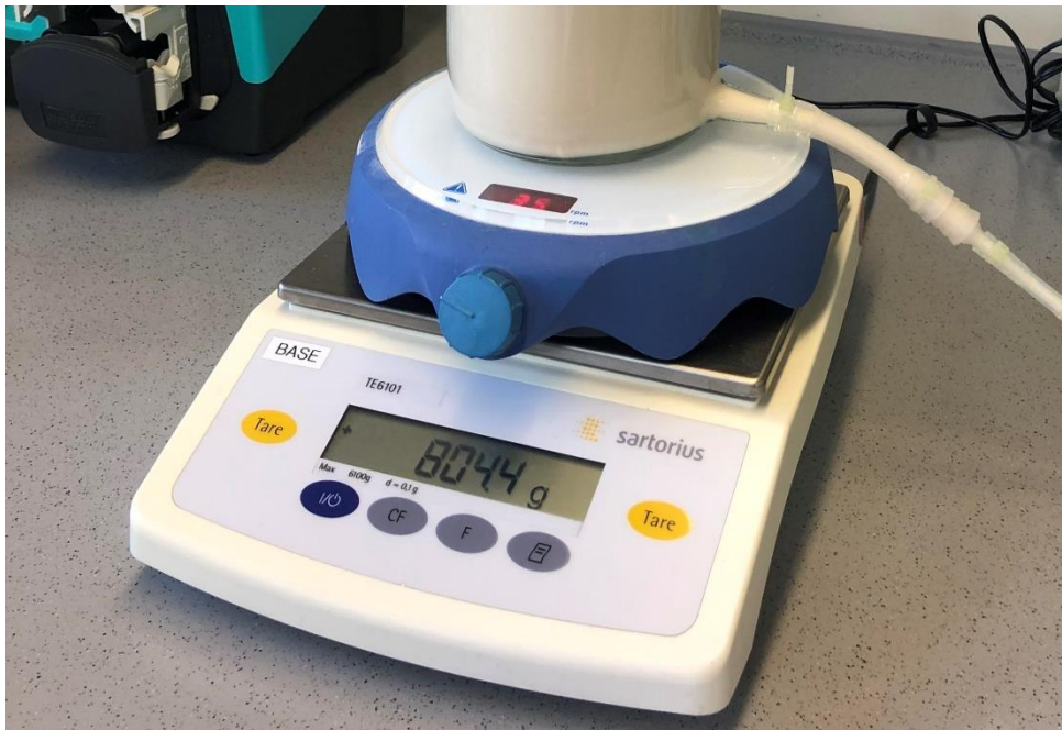
Abbildung 4.8: Nahaufnahme der Feedwaage und des darauf platzierten Magnetrührers.
