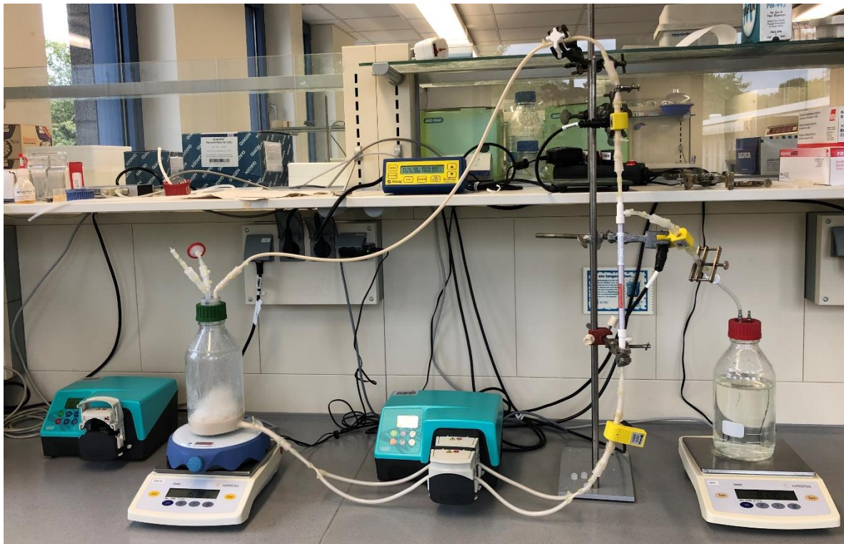
Abbildung 4.9: Tangentialflussfiltrationsanlage. Zu erkennen sind die einzelnen Baubestandteile: Permeatwaage, Permeatbehälter, Hohlfasermodule, Drucksensoren, Druckmonitor, retentatseitige und permeatseitige Schlauchklemme, 3-Wege-Ventil, Feedpumpe, Feedwaage, Magnetrührer, Feedbehälter und die Diafiltrationspumpe. Die Diafiltrationspumpe sowie der Diafiltrationsbehälter (nicht abgebildet) sind in diesem Bild abweichend vom Text nicht angeschlossen, da dieses Bild während einer laufenden Konzentrierung gemacht wurde. Der Laptop der Anlage befindet sich auf einem Schreibtisch gegenüber von der hier abgebildeten TFF-Anlage.
