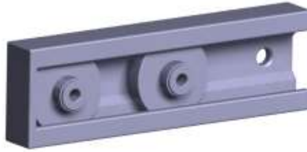
Abbildung 43: Schienensystem zur Verschiebung der Beinauflage
