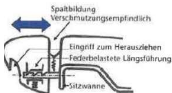
Abbildung 10: Sitzflächentieffenverstellung mit zweigeteiltem Sitzkissen [6]
