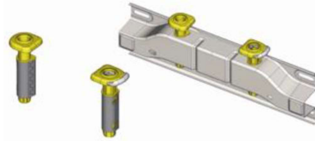
Abbildung 12: Kunststoffhülsen in Rückenlehnenstruktur [4]
