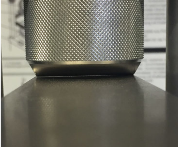
Abb. 31 Spalt zwischen Probe und 3PB-Stempel (eigene Darstellung)
