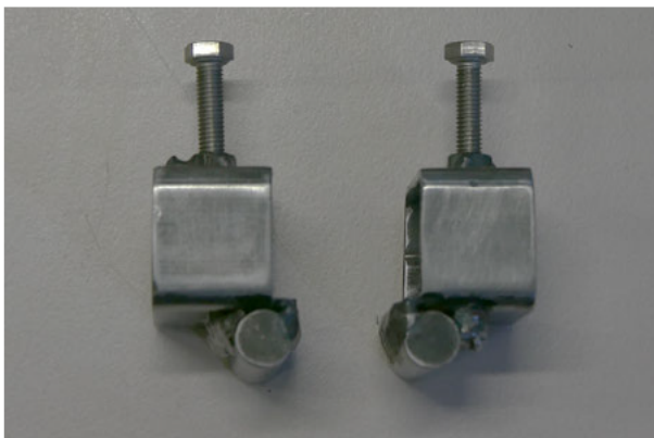
Abb. 26 Seitenansicht der Schlitten, mit verschobenen Druckpunkten (eigene Darstellung)
