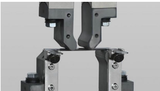
Abb. 8 Beispiel einer Vierpunktbiegung (aus Zwick/Roell 2020c )
