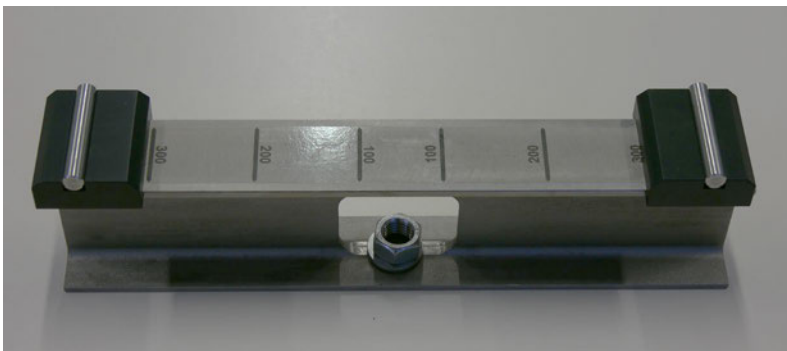
Abb. 21 I-Profil-Träger mit beiden Auflager und Sechskantmutter (eigene Darstellung)
