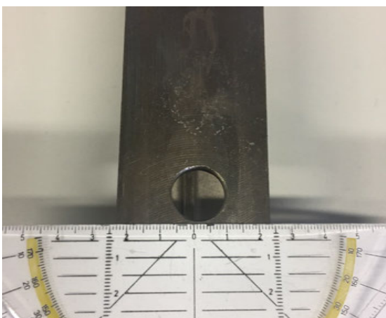
Abb. 32 Unsymmetrische Bohrung der Auflagerbasis, Ansicht v. unten (eigene Darstellung)
