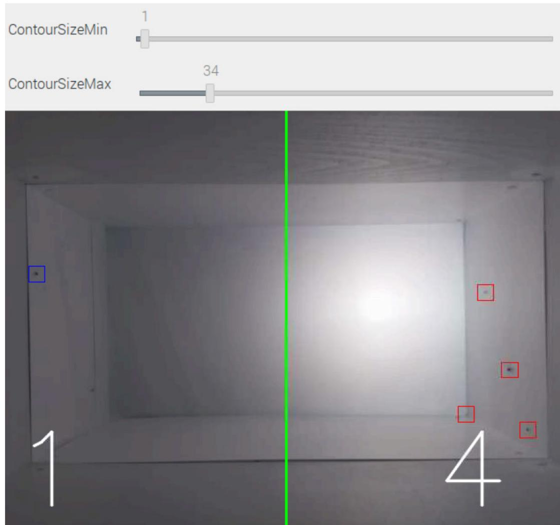
Abbildung 5.3: Testbildaufnahme von fünf Mücken im Testbereich
