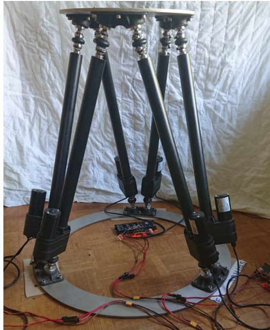
Abbildung 6.1: Prototyp der Stewart-Plattform in seiner Grundstellung
