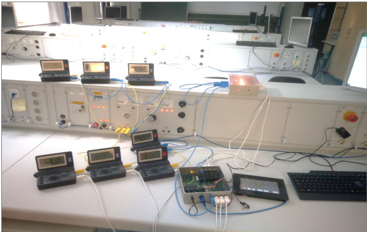
Abbildung 49: Prüfung der Messgenauigkeit im Spannungsbereich (Schaltungsaufbau)
