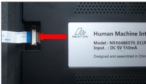
Abbildung 17: Flexkabel am Nextion Display (Rückseite)
